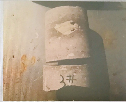
图6 磷石膏芯样切面中的未分散大颗粒
