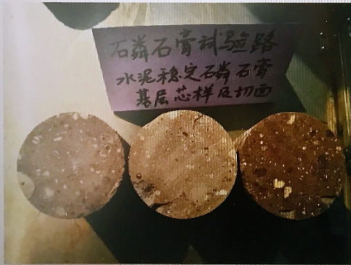
图7 磷石膏芯样切面中为分散的小颗粒
